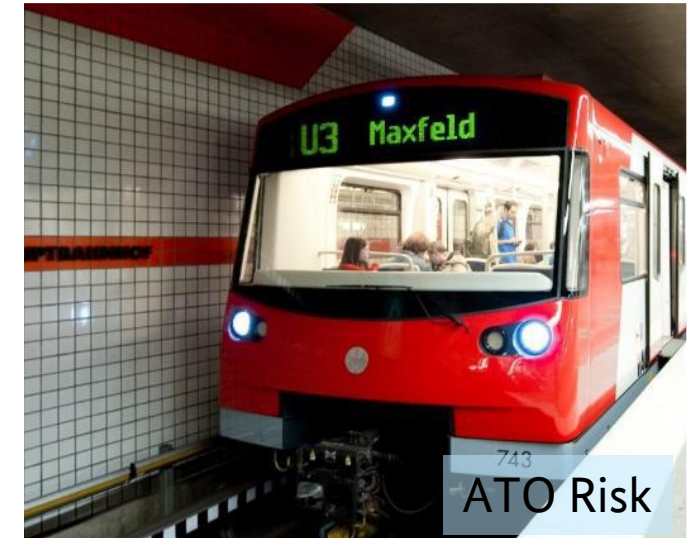
Automatische U-Bahn Nürnberg: GoA4 nach BOStrab aus Zwischenbericht ATO Risk
