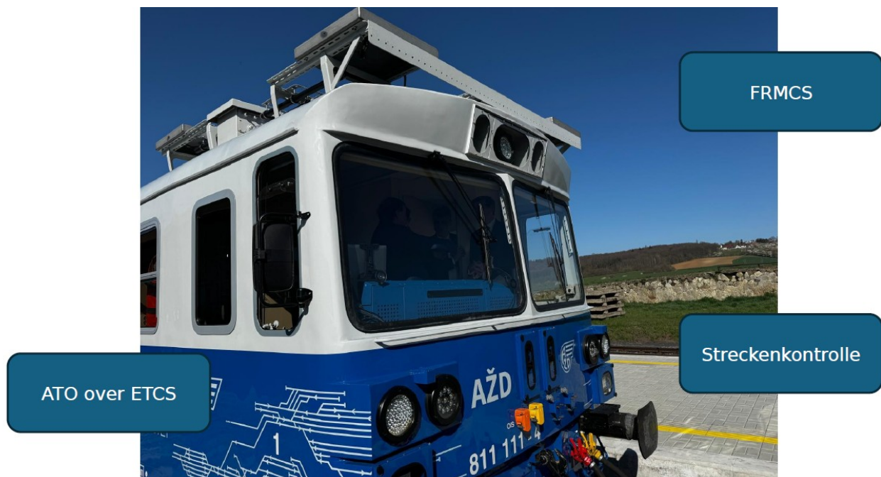
Abb. 1: Der Versuchszug EDITA der AZD auf der ETCS überwachten ATO-Versuchsstrecke Kopidlno – Dolci Busov der AZD hat zwischen April und Oktober 2025 bereits über 3000 Kilometer unfallfrei im fahrerlosen Fahrgastbetrieb zurückgelegt
